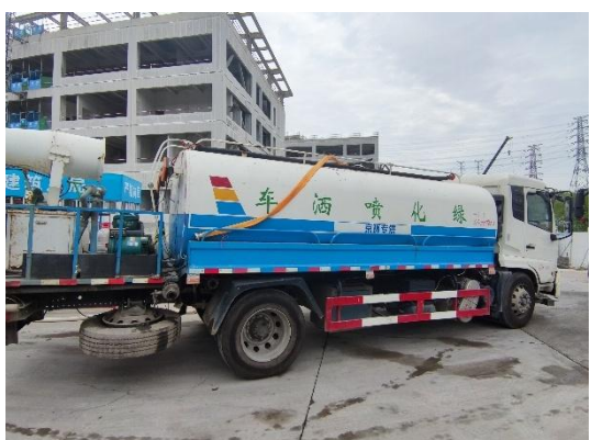
洒水降尘 防尘网覆盖 道路及管线工程区 (2024年7月)
