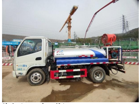
道路及管线工程区-洒水降尘 (2023年4月)
